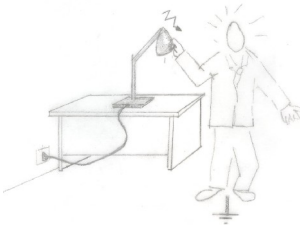
Fig.8 Esempio di contatto indiretto
